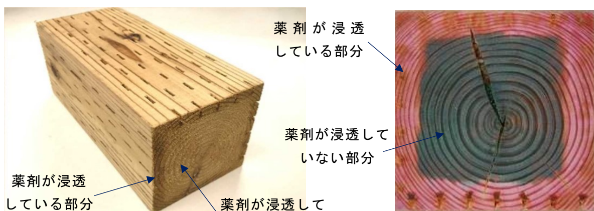
写真 1.3.3 呈色反応 *5 による 薬剤の湿潤状況の確認
